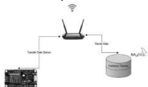
Gambar 10. Sistem jaringan NodeMCU ESP8266 ke database
