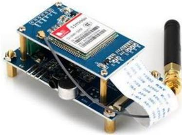
Gambar 2.7. Modul GSM/GPRS SIM900A
