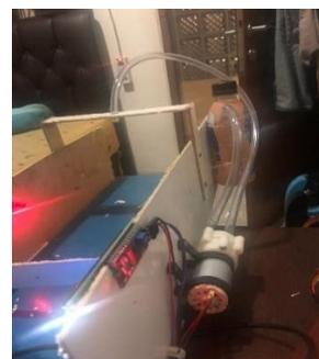
Gambar 15. Pengujian Pompa Disinfektan Ketika Tidak Menyemprotkan Disinfektan
