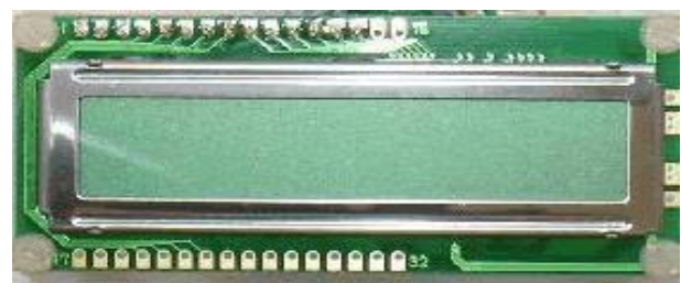
Gambar 2.7 Bentuk Fisik LCD
