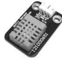
Gambar 2. Modul Sensor DHT11
