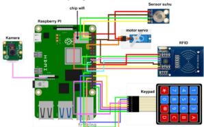
Gambar 5. Rangkaian Keseluruhan
